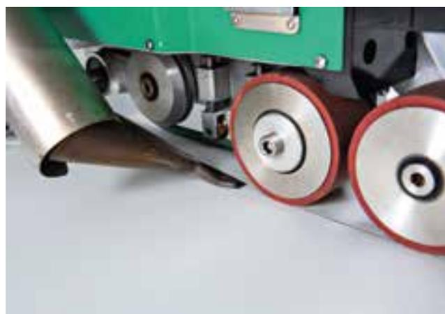
Saldatrice automatica ad aria calda.
