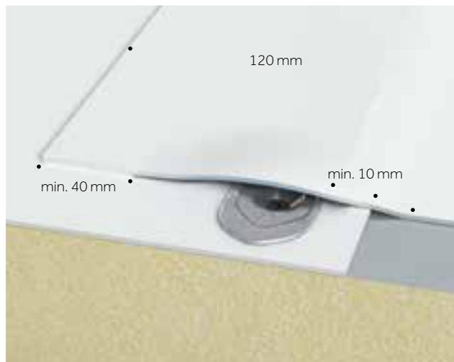
Sovrapposizione laterale con fissaggio rigido mediante placchetta acciaio 82x40mm.
