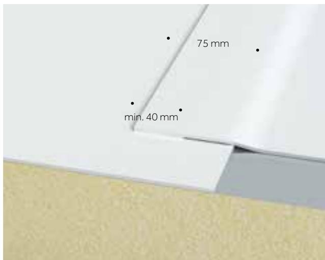
Saldatura sovrapposizione terminale (in testa del rotolo).
