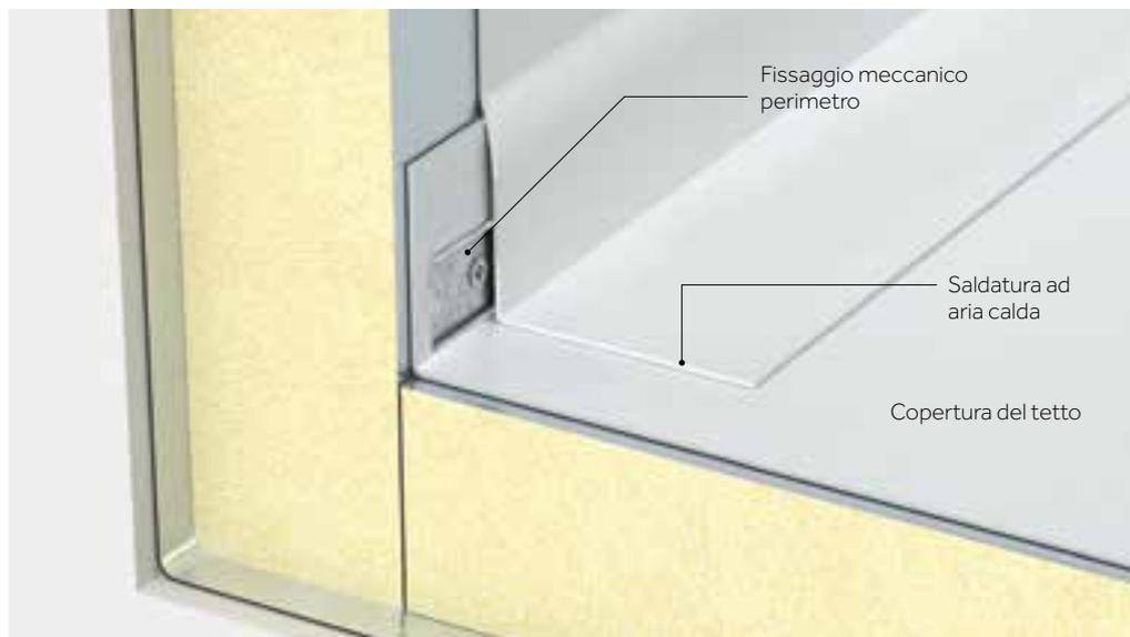
Fissaggio perimetrale mediante barra di fissaggio.
