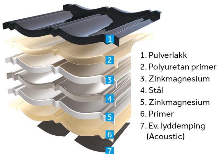
Figur 1, oppbygning av AeroDek Unique Plus
